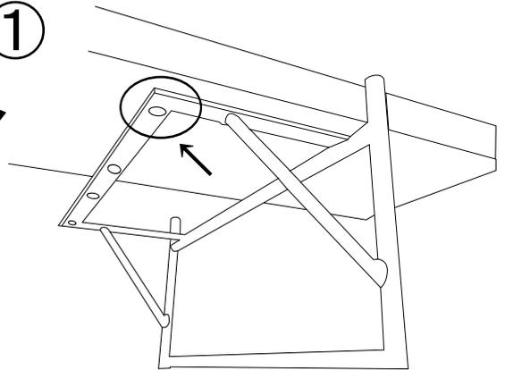
矢印の所で棚板と外側のフレームをネジで固定する。
